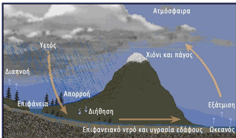
**Σχήμα 1.2** Αναπαράσταση των διεργασιών του υδρολογικού κύκλου (τροποποίηση από το πρόγραμμα COMET, <http://www.meted.ucar.edu>).
