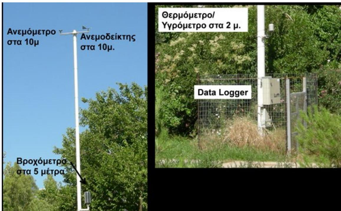
**Σχήμα 1.11** Ο αυτόματος μετεωρολογικός σταθμός του Χαροκόπειου Πανεπιστημίου. Αποτελείται από κυπελλοφόρο ανεμόμετρο και ανεμοδείκτη στα 10 μέτρα, βροχόμετρο στα 5 μέτρα, θερμόμετρο και υγρόμετρο στα 2 μέτρα και βαρόμετρο στον χώρο των καταγραφέα δεδομένων (data logger).
