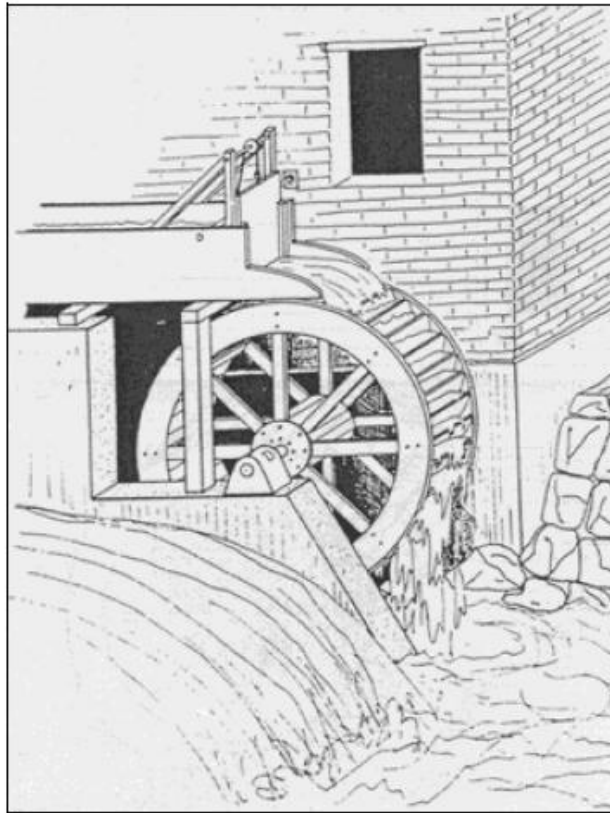
Υδροτροχός με εισαγωγή του νερού στο πάνω μέρος του τροχού.
