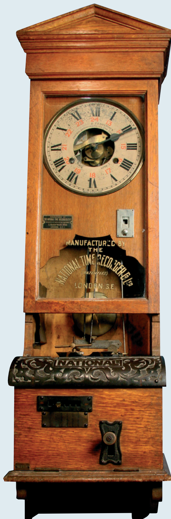
Το πρώτο ρολόι παρουσίας προσωπικού της Εθνικής Τράπεζας (δεκαετία 1920). Με το χτύπημα μιας κάρτας ελεγχόταν η άφιξη και αναχώρηση του προσωπικού. Συλλογή μηχανών γραφείου, Ιστορικό Αρχείο Εθνικής Τράπεζας.
