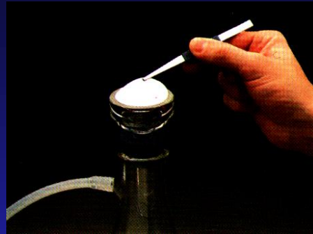
[Β] Τοποθέτηση αποστειρωμένης ηθιομεμβράνης στη συσκευή διήθησης
