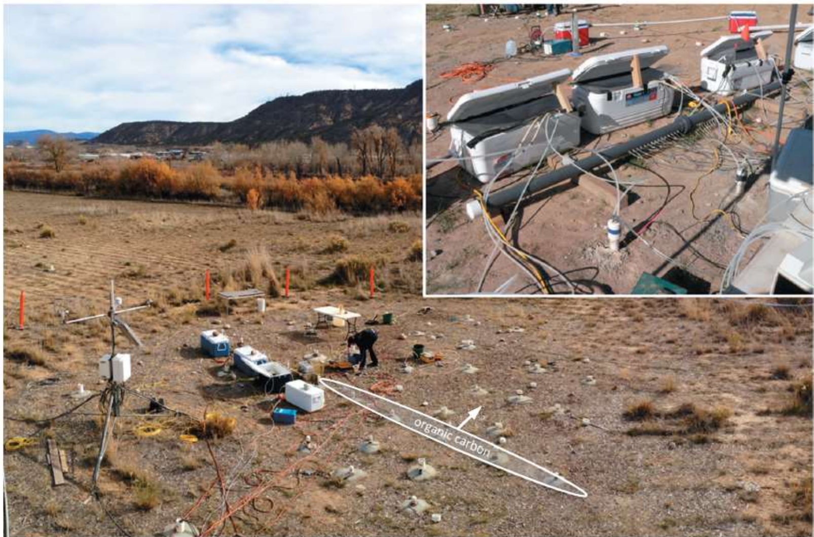
Εικόνα 21.6 Βιοαποκατάσταση ουρανίου. Πειραματική διάταξη του υπουργείου Ενέργειας των ΗΠΑ σε μια περιοχή μολυσμένη με ουράνιο. Οργανικός άνθρακας (οξικό οξύ) εγχέεται στο χώμα (ένθετη φωτογραφία) και διαχέεται μέσω των υπογείων υδάτων προς την κατεύθυνση που υποδεικνύει το βέλος στην κύρια φωτογραφία. Το οξικό οξύ είναι ο δότης ηλεκτρονίων για την αναγωγή του U^{6+} σε U^{4+} , η οποία και ακινητοποιεί το ουράνιο.
