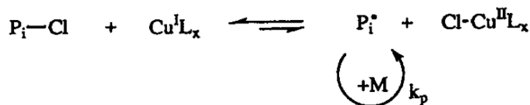
Σχήμα 3.8. Σύστημα ΡΠΜΑ με \text{Cu}^{\text{I}} .
