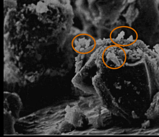
Σωματίδια μη συνδεδεμένης πυριτίας με λειοτριβημένο ιστό: η συνέχεια του ιστού έχει καταστραφεί αλλά ο ιστός δεν έχει διασπαρεί ομοιόμορφα σχηματίζοντας συσσωματώματα
