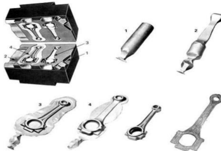
Σχήμα 2. Σύνθετο καλούπι σφυρηλάτησης διωστήρα. Φέρει τέσσερις κοιλότητες, η κάθε μία από τις οποίες παράγει διαφορετικό στάδιο (από το 1 μέχρι το 3) του τεμαχίου μέχρι το τελικό (το 4). Το αρχικό υλικό που χρησιμοποιείται έχει μορφή κυλίνδρου.
