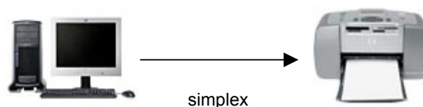
Σχήμα- : Παράδειγμα επικοινωνίας simplex: Αποστολή data από Η/Υ σε εκτυπωτή.
