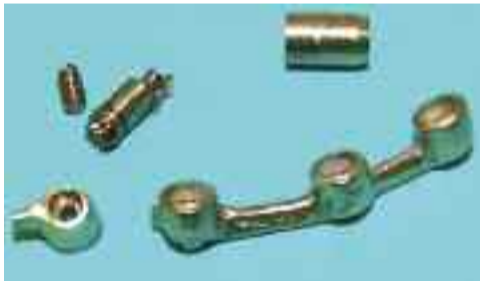
Εικ. 7: Θραύση δοκού και βίδας διαβλενογονίου στηρίγματος.
