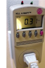
Tweet-a-watt: Μετρητής ενεργειακής κατανάλωσης
