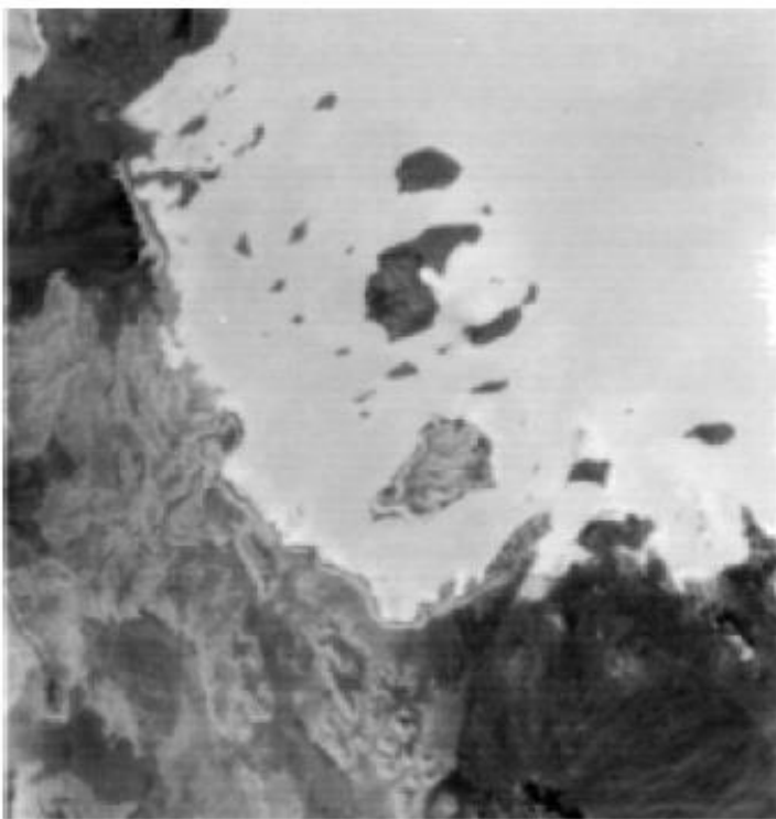
Εικόνα 6.9 Σε αυτή τη νυχτερινή θερμική υπέρυθρη εικόνα της Βόρειας Ερυθραίας και της Ερυθράς Θάλασσας, το νερό είναι θερμότερο από την επιφάνεια της Γης και ως εκ τούτου εμφανίζεται με πιο φωτεινούς τόνους εικονοστοιχείων στο επάνω δεξιά τμήμα της εικόνας. Οι παραλλαγές στη φωτεινότητα στην ξηρά αφορούν τις μεταβολές στις θερμικές ιδιότητες και, σε μικρότερο βαθμό, στην τοπογραφία.
