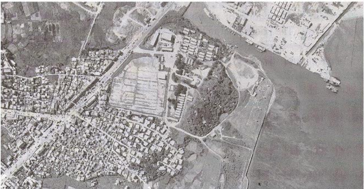
Εικόνα 5.39 Θεμελιώδη χαρακτηριστικά ερμηνείας μιας εικόνας: Μέγεθος: μικρά πλοία και μεγάλα εμπορικά πλοία. Σχήμα: σχεδόν τετράγωνες οικίες- ακανόνιστο σχήμα για τα χαμηλά παλαιά σπίτια Σκιά: ύψος κτιρίων Τόνος: σκούροι τόνοι για το δάσος και ανοιχτοί τόνοι για τις καλλιεργούμενες εκτάσεις Διάταξη: η κατανομή των κτιρίων στην αστική περιοχή
