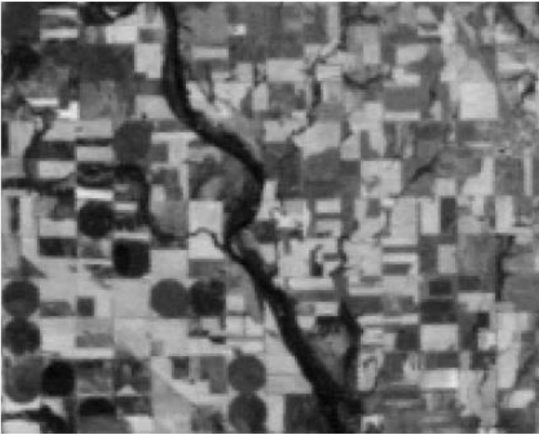
Εικόνα 6.8 Η σχετικά ψυχρή επιφάνεια του ποταμού, οι δασικές λωρίδες στις όχθες του ποταμού και τα πεδία των πλήρως αναπτυγμένων καλλιεργειών εμφανίζονται με σκούρα εικονοστοιχεία, ενώ τα φωτεινότερα εικονοστοιχεία αντιστοιχούν σε γυμνό έδαφος σε αυτή την ημερήσια καλοκαιρινή λήψη από τον Landsat 7 ETM+, φασματικό κανάλι 6 και χωρική διακριτική ικανότητα 60 μέτρα/pixel.
