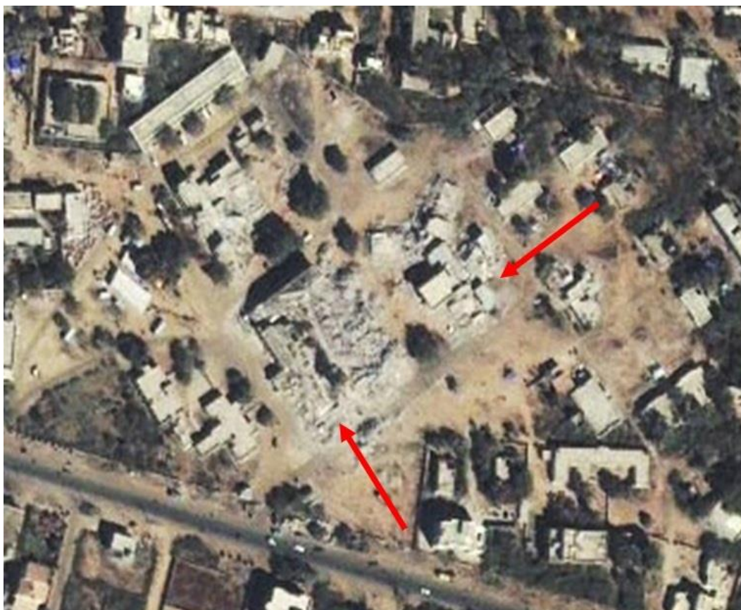
Εικόνα 8.13 Στη μέση της δορυφορικής εικόνας Ikonos φαίνονται καθαρά δύο κτίρια που έχουν υποστεί ολική ή μερική κατάρρευση στην περίπτωση του σεισμού της Ινδίας ( Parcharidis et al. 2002 ).
