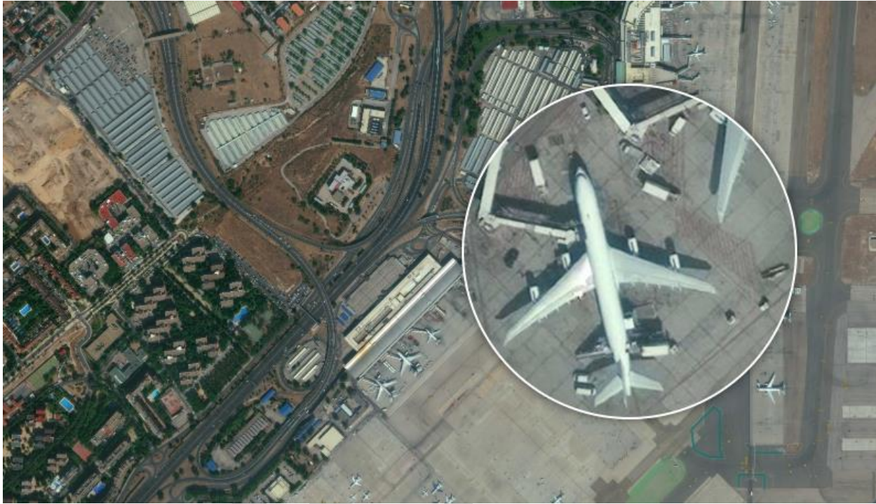
Σχήμα 34: Δορυφορική εικόνα του δορυφόρου WorldView-3 από το Αεροδρόμιο της Μαδρίτης Barajas στην Ισπανία με διακριτική ικανότητα (χωρίς ηλεκτρονική επεξεργασία) στα 31 cm.
