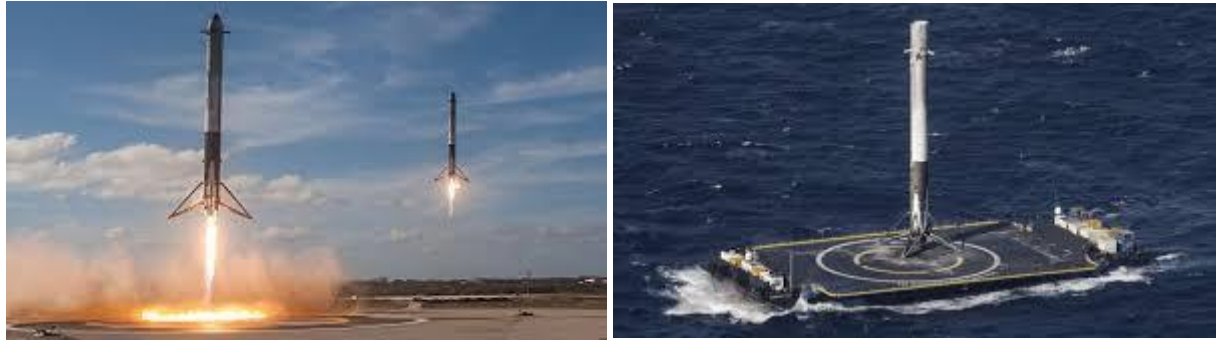
Σχήμα 27: Προσγείωση των προωθητών (booster) του Falcon 9 Heavy το 2018, Προσγείωση του προωθητή Falcon 9 στην τηλεκατευθυνόμενη πλατφόρμα 'Of Course I still love you' (2016)
