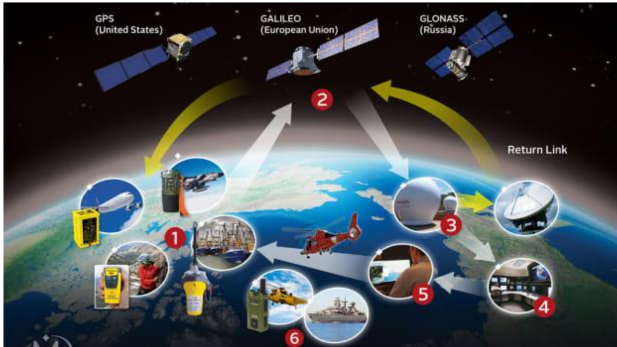
Σχήμα 38 Αρχιτεκτονική Λειτουργίας του Συστήματος Cospas-Sarsat
