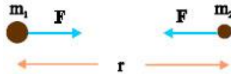
Σχήμα 51: Δυο σημειακές μάζες που απέχουν απόσταση r έλκονται με δύναμη που είναι ανάλογη του γινομένου των μαζών και αντίστροφα ανάλογη του τετραγώνου της απόστασής τους.
