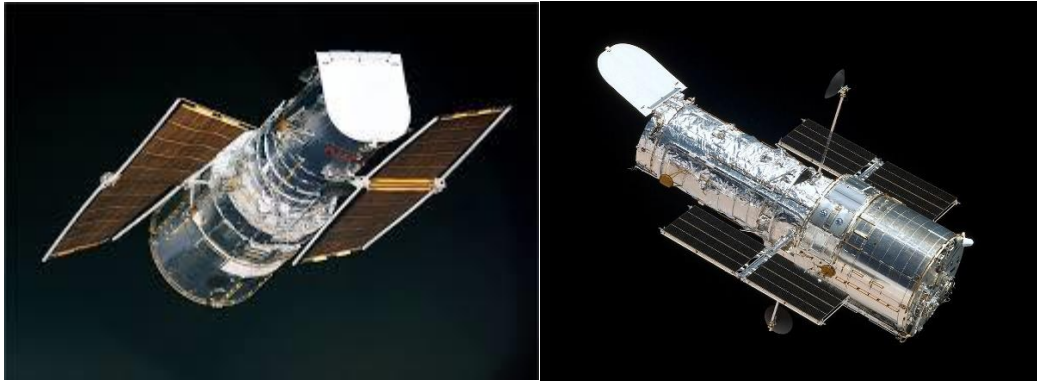
Σχήμα 2: (Αριστερά) Το διαστημικό τηλεσκόπιο Hubble με παραμορφωμένες ηλιακές συστοιχίες (Δεξιά) Νέες στιβαρές ηλιακές συστοιχίες που εγκαταστάθηκαν σε αποστολή του Διαστημική Λεωφορείου το 1993 και το 2002 1
