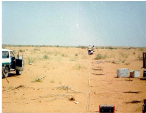
Στιγμιότυπο ανάπτυξης γραμμής γεωφώνων σε πείραμα σεισμικής διάθλασης που διεξήγαγε ο Τομέας Γεωφυσικής του Πανεπιστημίου Αθηνών στην έρημο Dahna της Σαουδικής Αραβίας για τον εντοπισμό κοιτάσματος χαλκίων (Saudi Government Railways Organization, Dammam 1983).
