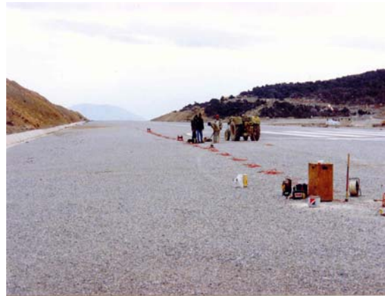
Στιγμιότυπο ανάπτυξης σεισμικής γραμμής σε πείραμα σεισμικής διάθλασης που διεξήγαγε ο Τομέας Γεωφυσικής του Πανεπιστημίου Αθηνών στη πίστα του αεροδρομίου της Ικαρίας στα πλαίσια γεωερευνητικών εργασιών για την επέκταση του αεροδιαδρόμου (ΓΓΜΕ, 1996).
