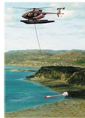
Ελικόπτερο με αναρτημένο μαγνητόμετρο σε αερομαγνητική έρευνα (FUGRO Survey Ltd).
