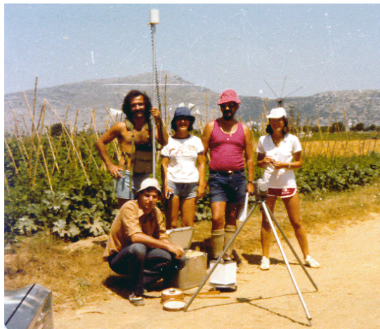
Φοιτητές του Γεωλογικού Τμήματος του Πανεπιστημίου Αθηνών στα πλαίσια γεωφυσικής έρευνας στο Οροπέδιο Λασιθίου Κρήτης (Ιούλιος 1980). Διακρίνεται το πυρηνικό μαγνητόμετρο πίσω, σε πρώτο πλάνο δεξιά το μαγνητόμετρο κατακόρυφης συνιστώσας και αριστερά το βαρυτόμετρο.
