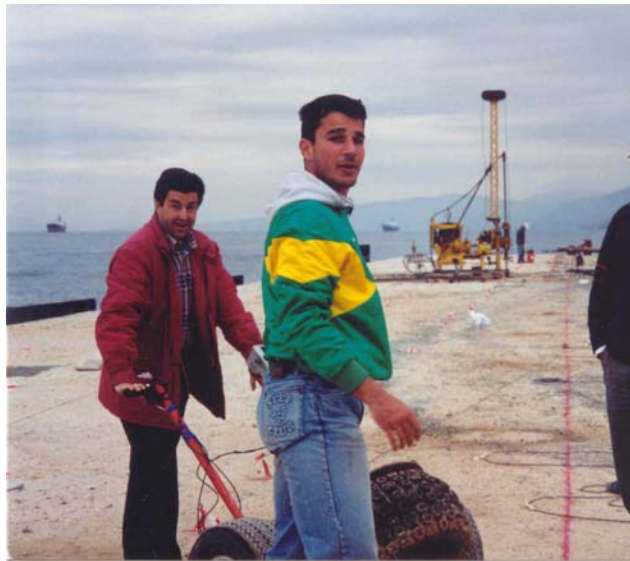
Γεωφυσικό συνεργείο του Τομέα Γεωφυσικής ενώ ρυμουλκεί συσκευή όπλου (Betsy Gun) για την παραγωγή σεισμικών κυμάτων σε πείραμα σεισμικής διάθλασης στη νησίδα Ρεβυθούσα (1997, Δημόσια Επιχείρηση Παροχής Λεπίου, ΔΕΠΛ).
