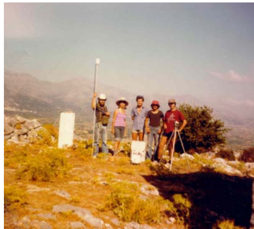
Φοιτητές του Γεωλογικού Τμήματος του Πανεπιστημίου Αθηνών στα πλαίσια γεωφυσικής έρευνας στο Οροπέδιο Λασιθίου Κρήτης (Ιούλιος 1980). Διακρίνεται το πυρηνικό μαγνητόμετρο πίσω, σε πρώτο πλάνο δεξιά το μαγνητόμετρο κατακόρυφης συνιστώσας και αριστερά το βαρυτόμετρο.
