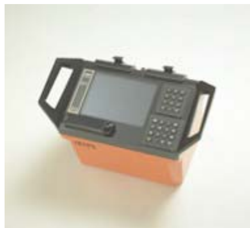
Σεισμογράφος τύπου Terraloc Mark 6 του οίκου ABEM ( http://www.abem.se ).
