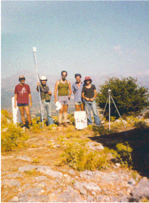
Γεωφυσικό συνεργείο του Τομέα Γεωφυσικής σε εργασίες μέτρησης του βαρυτικού και μαγνητικού πεδίου της Γης στο Οροπέδιο Λασιθίου Κρήτης. Εις το μέσον διακρίνεται ο συγγραφέας των σημειώσεων πλαισιούμενος από φοιτητές που χειρίζονται το πρωτονικό μαγνητόμετρο (αριστερά), το μαγνητόμετρο στρέψης Askania στον τρίποδα (δεξιά) και το βαρυτόμετρο LaCoste (μέσον). (Λασιθί, Αύγουστος 1980).
