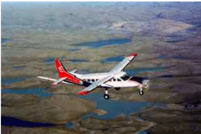
Αεροσκάφος τύπου Cessna 208B σε αερομαγνητική έρευνα υπεράνω της Γροιλανδίας. Στο αεροσκάφος είναι προσαρμοσμένο ένα ουραίο κεντρί μήκους 3 μέτρων από άκαμπτο κράμα αλουμινίου (μη μαγνητικό υλικό) σχεδιασμένο να μεταφέρει τον αισθητήρα του μαγνητομέτρου (SANDER GEOPHYSICS Ltd., Ottawa Canada).
