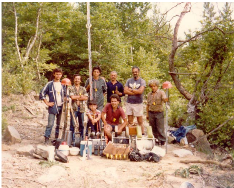
Γεωφυσικό συνεργείο του Τομέα Γεωφυσικής του Πανεπιστημίου Αθηνών στα πλαίσια σεισμικής έρευνας διάθλασης στο ποταμό Άραχθο. Σε πρώτο πλάνο διακρίνονται τα γεώφωνα (κίτρινα) καρφωμένα στο έδαφος, τα καρούλια με τα καλώδια των γεωφώνων, το χαρτοκιβώτιο με τις ράβδους του δυναμίτη πίσω από τα γεώφωνα για την παραγωγή σεισμικής ενέργειας και οι συσκευές επικοινωνίας μεταξύ του προσωπικού. Στα αριστερά της πίσω σειράς διακρίνεται ο τοπογράφος με τον εξοπλισμό του και στο άκρο δεξιά ο πυροδότης (γομωτής) των εκρηκτικών (ΔΕΗ, ΥΠΕ Στενού, 1978).
