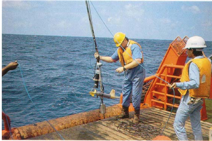
Προετοιμασία καταβύθισης θαλάσσιου μαγνητομέτρου στα πλαίσια θαλάσσιας γεωφυσικής έρευνας (FUGRO Survey Ltd.)
