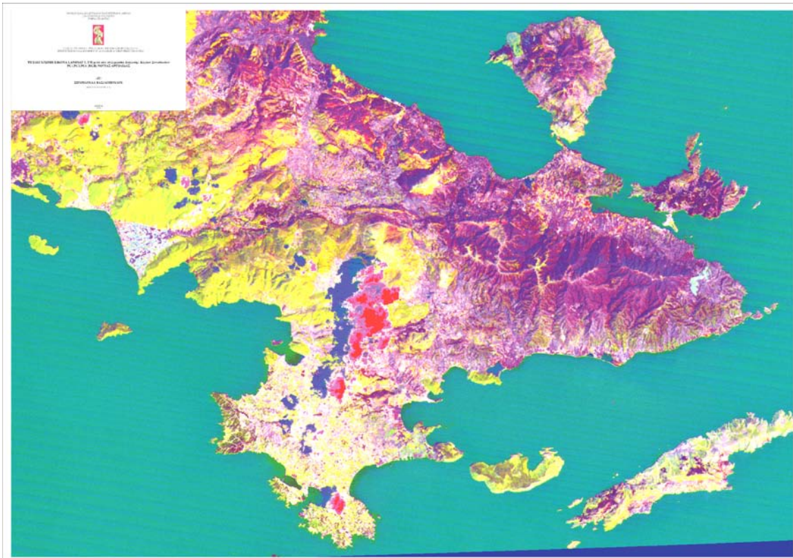
Εικόνα 14.38. Ο συνδυασμός των συνιστωσών PC6-3-1, δίνει την αναγκαία πληροφορία για τους σκοπούς της μελέτης. Καταγράφονται με μεγάλη ευκρίνεια τα μορφολογικά χαρακτηριστικά της περιοχής, το υδρογραφικό δίκτυο και οι καλυμματικοί τύποι (αλλούβια, κώνοι κορημάτων κ.ά), χαρακτηριστικά τα οποία αποτελούν άμεσα ή έμμεσα κριτήρια αναγνώρισης δομών. (Βασιλοπούλου, 1999).
