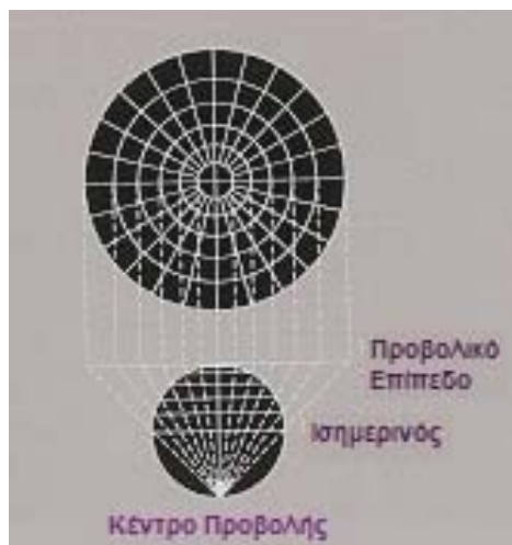
Εικόνα 5.3. Στις στερεογραφικές απεικονίσεις κέντρο προβολής θεωρείται το αντιδιαμετρικό σημείο του σημείου επαφής του επιπέδου προβολής ( http://erg.usgs.gov/isb/pubs/MapProjections/graphics )
