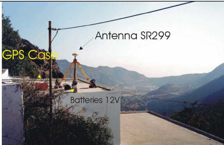
Εικόνα 4.2. Δέκτης GPS μετρήσεων στον Εμπορειό Νισύρου, κατά την διάρκεια Γεωδαιτικών Μετρήσεων στην Νίσυρο από τον Τομέα Γεωφυσικής-Γεωθερμίας του Τμ. Γεωλογίας & Γεωπεριβάλλοντος, ΕΚΠΑ.
