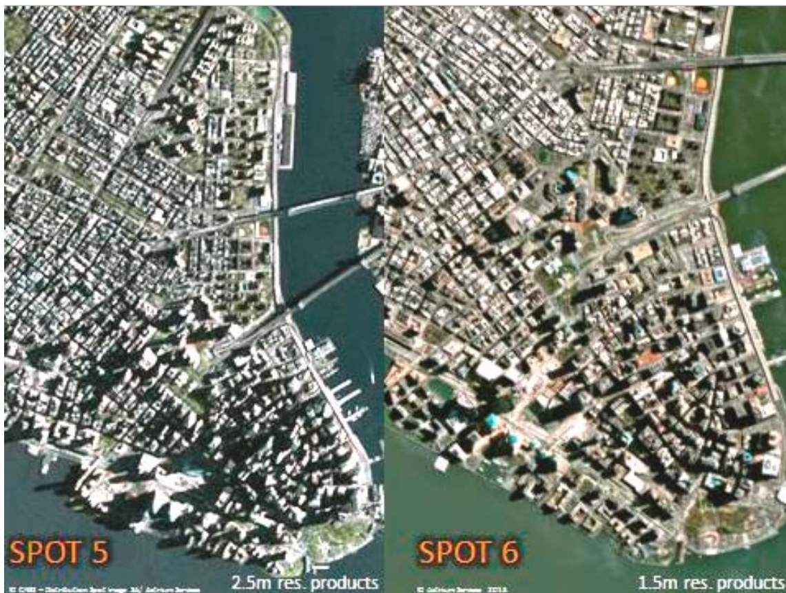
Εικόνα 11.2. Σύγκριση εικόνων SPOT 5 (2.5 m) και SPOT 6 (1.5 m) από την Νέα Υόρκη ( http://www.astrium-geo.com/en/147-spot-6-7-satellite-imagery ).
