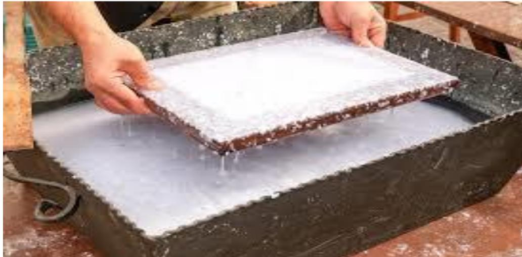
4. Gautscher: Papier wird auf Filz gelegt und gedrückt. Es wird "abgegautscht". Erste Entwässerung
