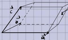
$$\text{Εγκάρδο παραδου = Εμβ βιασης} \times γ_ψος \\ = \|\vec{a} \times \vec{b}\| \cdot \|\vec{p}_a \times \vec{c}\|$$
