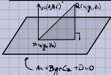
$$\text{Απόσταση του } Q \text{ από το επίπεδο} = \|\vec{p}_q \cdot \vec{PQ}\| \\ = \frac{\|\vec{PQ} \cdot \vec{V}\|}{\|\vec{V}\|^2} = \frac{|\vec{PQ} \cdot \vec{V}|}{\|\vec{V}\|^2} = \frac{|A(x - x_0) + B(y - y_0) + C(z - z_0)|}{\sqrt{A^2 + B^2 + C^2}} \\ = \frac{|Ax_1 + By_1 + Cz_1 + (-Ax_0 - By_0 - Cz_0)|}{\sqrt{A^2 + B^2 + C^2}} \\ = \frac{|Ax_1 + By_1 + Cz_1 + D|}{\sqrt{A^2 + B^2 + C^2}}$$
