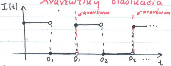
Μηχανή που εναλλάσσεται σε περιόδους λειτουργίας (operating)  $O_1, O_2, \dots$  και αργίας (down)  $D_1, D_2, \dots$
