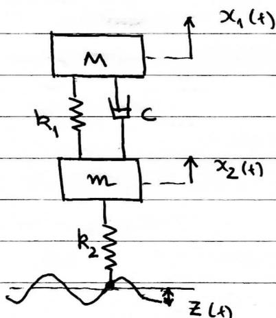
$$\begin{cases} M x_1'' = -k_1(x_1 - x_2) - c(x_1' - x_2') \\ m x_2'' = k_1(x_1 - x_2) + c(x_1' - x_2') - k_2(x_2 - z) \end{cases}$$
