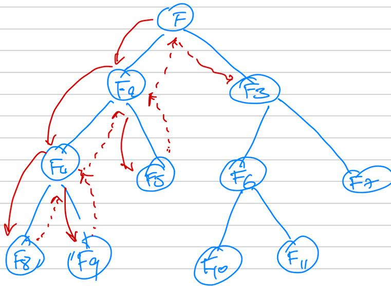
depth first  $F_1 \rightarrow F_2 \rightarrow F_4 \rightarrow F_8 \rightarrow F_9 \rightarrow F_5 \rightarrow F_3 \rightarrow F_6 \rightarrow F_{10} \rightarrow F_{11} \rightarrow F_7$
