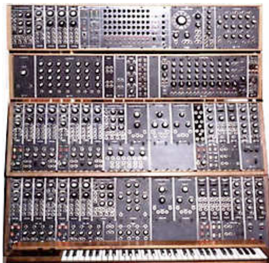
εικ.7.5. Ένας τύπος συνθεσαίζερ Moog, με ένα αριθμό modules-εισόδων χωρίς τα patchcords συνδέσεως.
