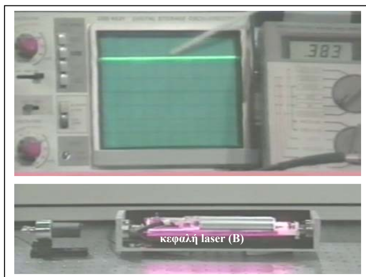
Εικόνα 18. Όταν ανάβει η λυχνία laser HeNe (B) εκπέμπεται η αυθόρμητη ακτινοβολία (ροζ απόχρωσης), ενώ το υλικό του υπό αναστροφή πληθυσμού ενισχύει τη δέσμη laser (A) από 364 mV στα 383 mV.
