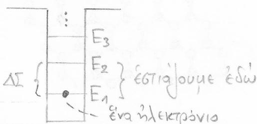
$$dW_{\text{απορ}}^{\text{εf}} = B_{12} \rho(v, T) dt \quad \begin{array}{l} \text{Έφαγκασμένη} \\ \text{απορρόφηση} \end{array}$$
