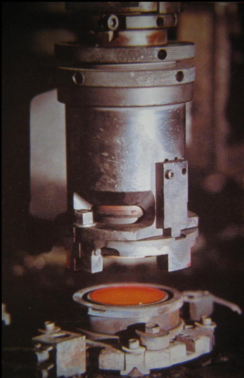
Δημιουργία κυλινδρικού δίσκου σε καλούπι
