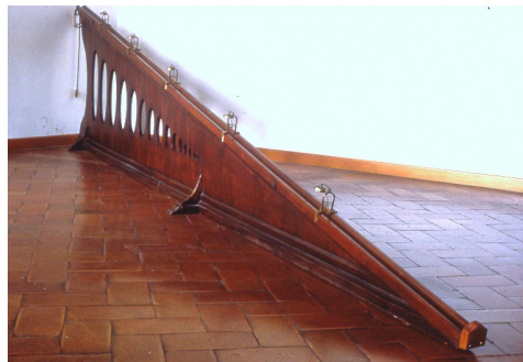
Σχήμα 1.2: Σύγχρονη ανακατασκευή του κεκλιμένου επιπέδου που χρησιμοποίησε ο Γαλιλαίος. Τα καμπανάκια σε συγκεκριμένες θέσεις κατά μήκος του επιπέδου ίσως να είχαν χρησιμοποιηθεί από το Γαλιλαίο προκειμένου να μετράει με τα δοχεία νερού το χρόνο.
