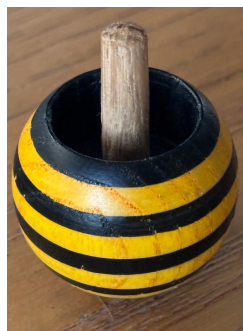
Σχήμα 1: Το tippe top (αριστερά) όταν τοποθετηθεί σε ένα μη λείο τραπέζι με μεγάλη κατακόρυφη γωνιακή ταχύτητα και με την σφαιρική επιφάνεια προς τα κάτω με την πάροδο του χρόνου θα αναστραφεί όπως φαίνεται στο σχήμα.
