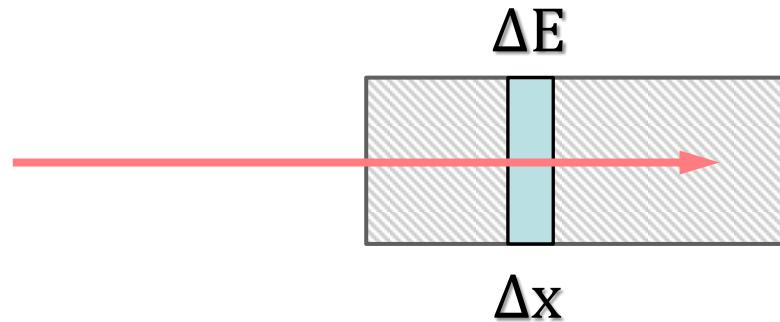
Το φορτισμένο σωματίδιο χάνει ενέργεια  $\Delta E$  στο διάστημα  $\Delta x$
