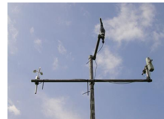
Αισθητήρες ανέμου, θερμοκρασίας και υγρασίας στον ιστό
