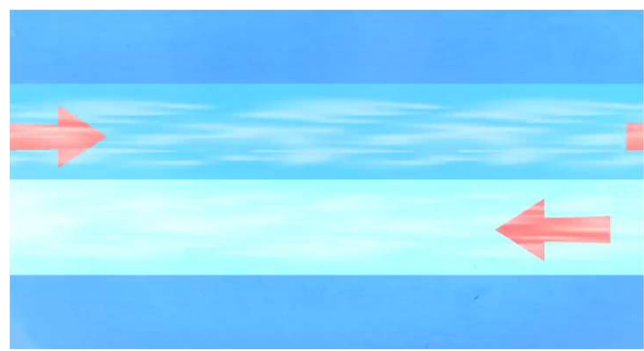
1. Για ευκολία θεωρούμε ότι τα στρώματα των υλικών εκατέρωθεν διεπιφάνειας κινούνται σε αντίθετη κατεύθυνση.
