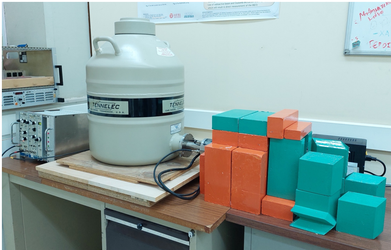
Εικόνα 8 - Ο ανιχνευτής HPGe. Ο κρύσταλλος περιβάλλεται από μολυβδότουβλα συνολικού πάχους 10cm για μείωση του υποβάθρου λόγω κοσμικής ακτινοβολίας. Είναι εμφανές το δοχείου υγρού αζώτου (LN2) το οποίο διατηρεί τον κρύσταλλο σε χαμηλές θερμοκρασίες. Αριστερά διακρίνεται η κονσόλα NIM με τις μονάδες υποστήριξης (τροφοδοτικό υψηλής τάσης και ενισχυτής σήματος).
