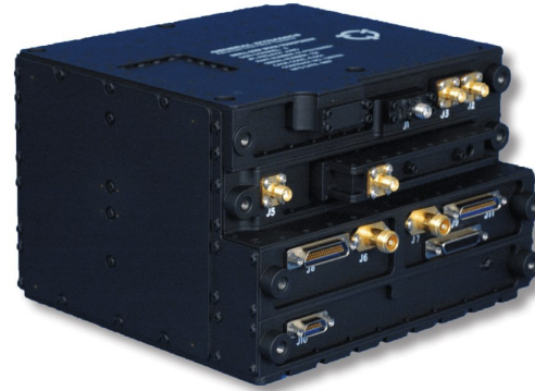
Αναμεταδότης εξερευνητικών διαστημικών σκαφών ζωνών X & Ka της General Dynamics
